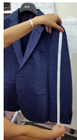
Sl.7 Audit kontrola na muškom sakou: a) mjerenje duljine leđa; b) mjerenje duljine rukava
