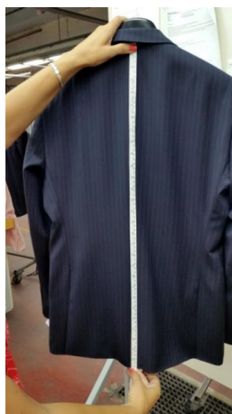
Sl.7 Audit kontrola na muškom sakou: a) mjerenje duljine leđa; b) mjerenje duljine rukava
