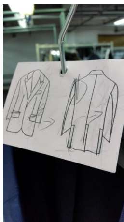
Sl.6 Radno mjesto završne kontrole: a) transportni stalci za neispravne sakoe, b) kontrolna kartica s označenim pogreškama, c) računalo za unos podataka
