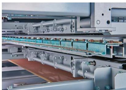
Sl.2 Središte rasteznog sušionika Montex – specijalni lanac sa zabrtvljenim ležajevima
