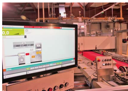
Sl.1 Intuitivno upravljanje svih parametara pomoću najnovijeg sustava vizualizacije na stroju Qualitex 800 PLC s monitorom od 24 inča
