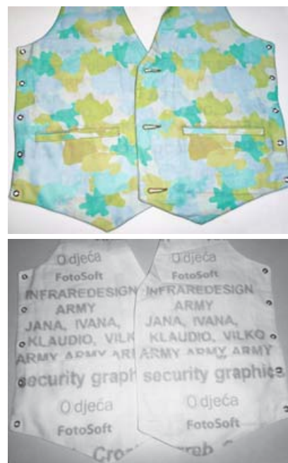
Sl.11 Zelenkasta uniforma s informacijama u infracrvenom (dolje) sakrivenim u vidljivom spektru (gore)
