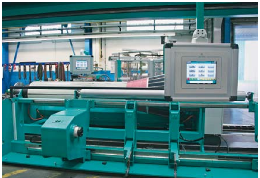
Sl.5 Položaj operativnih sučelja na sekcionalnoj snovaljki Nov-O-Matic 2
