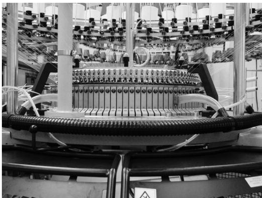
Sl.1 Relanit 3.2 II, strojna glava velike brzine s MCS (Mayerov sustav čišćenja): zbog otvora u segmentima nastaje oko pletaće glave kanal kroz koji se puše zrak za čišćenje i hlađenja
