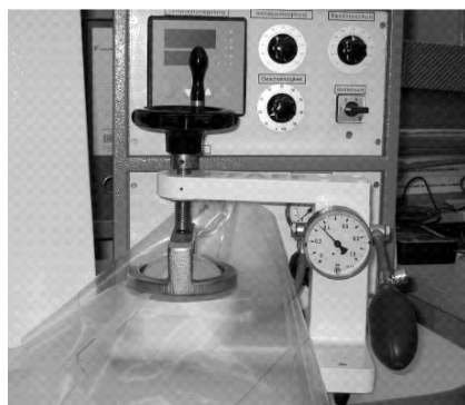
Sl.9 Uređaj za ispitivanje zrakopropusnosti šavova tvrtke Pfaff
