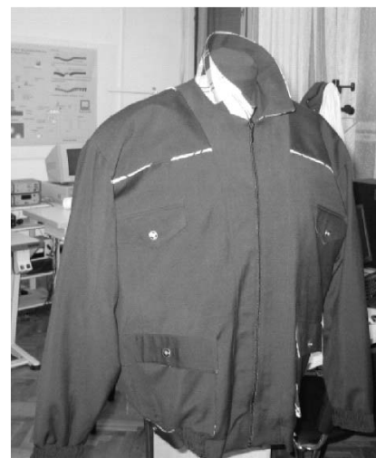
Sl.8 Vanjska školjka inteligentnog odjevnog predmeta s aktivnom termičkom zaštitom
