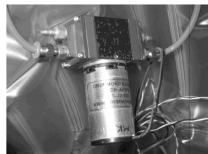
Sl.19 Mikrokompresor za punjenje termoizolacijskih komora priključen na zrakovodni sustav
